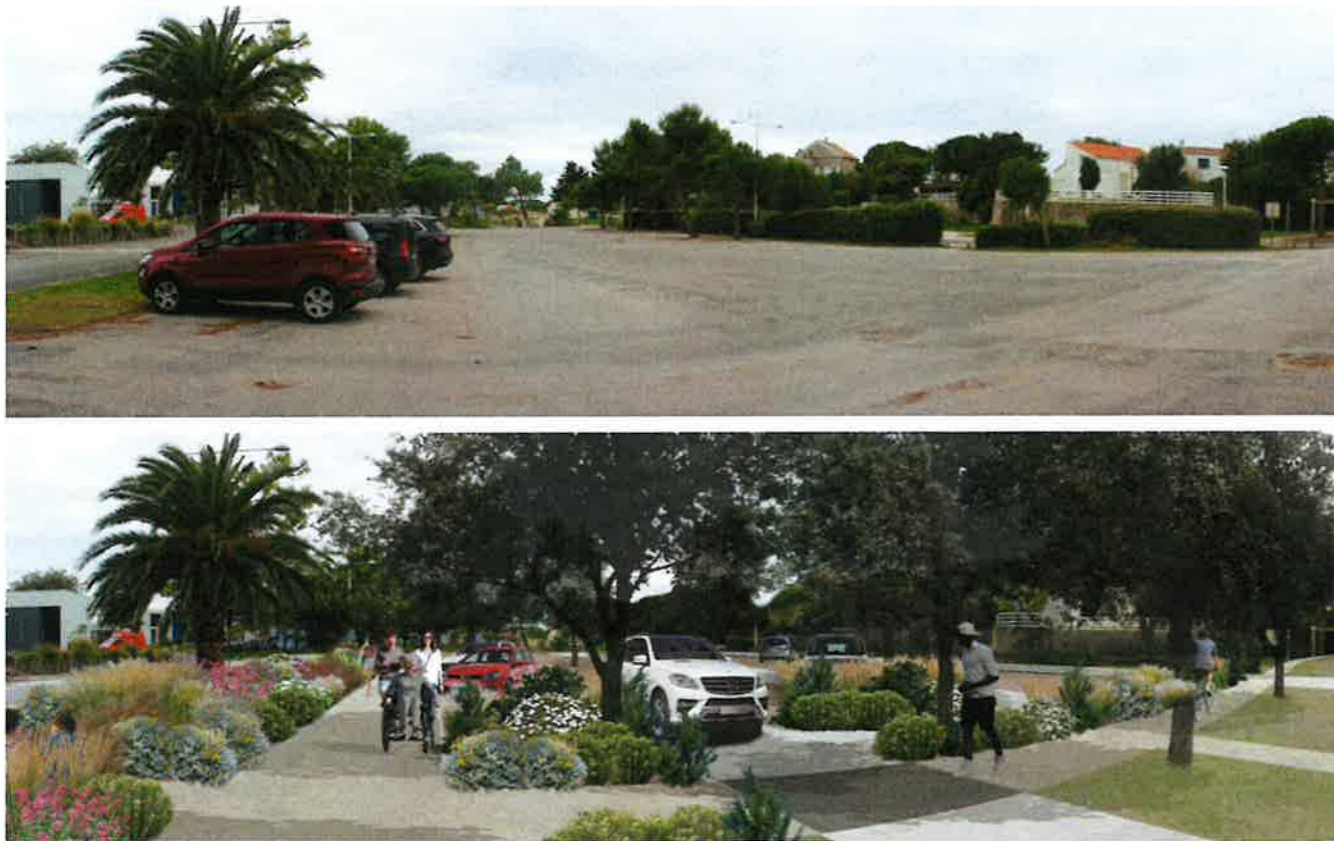
Figure 3 - Illustration du projet : Requalification des espaces de stationnement (recul des emprises accessibles aux voitures, réduction des surfaces imperméabilisées, amélioration de la qualité paysagère...) sécurisation des déplacements piétons / cycles et confortement des aménités paysagères dus ite
